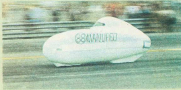
„Manuped“ Freda Tača, izgrađen od bambusa, plastike, žice i kartona
