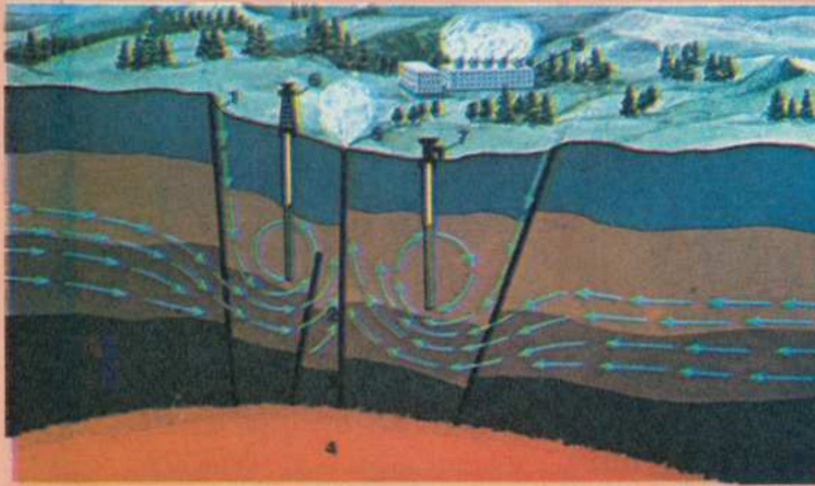
Geotermalna elektrana u Gejzirima, u Kaliforniji: Kišnica se prirodnim procesom spušta kroz pukotine (1) i porozne stene (2) do kamene podloge (3), gde stvara podzemno jezero, koji se, preko podloge, zagreva toplotom magme (4) i voda se pretvara u paru, pa kroz pukotine dospeva na površinu (5); voda prolazi jednu bušotinu (6), pretvara se u paru i kroz drugu bušotinu (7), stiže do generatorskog postrojenja (8)
