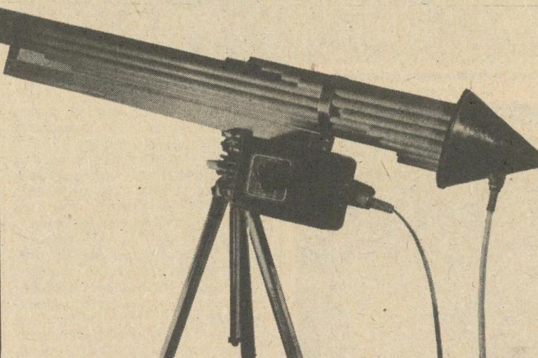
Izgled „zvučnog durbina“ koji radi na principu rezonancije zvuka u rezonantnim cevima određenih dužina
