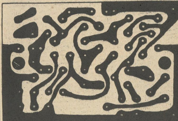
Izgled štampane pločice. Pre pravljenja treba proveriti da li se elektronski delovi mogu ukloniti na predviđeno mesto, jer se vrlo često razlikuju po veličini, zavisno od fabrike koja ih proizvodi. U tom slučaju korekcije treba na vreme izvršiti
