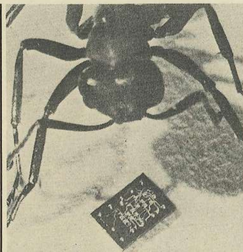
MANJA OD MRAVA: OVA MIKROPLOČA, PROIZVOD FIRME IBM, SADRŽI ČAK 70 KOMPONENATA
