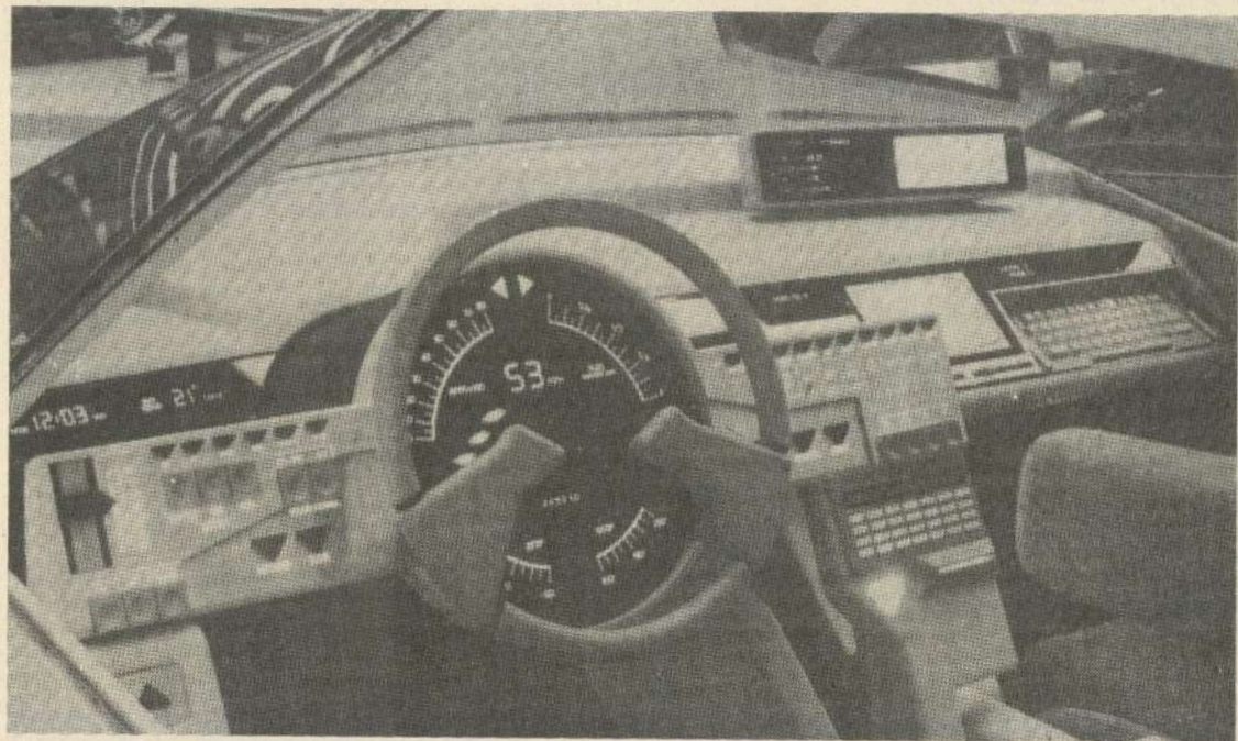
Aktivna primena elektronike: Komandna tabla „Fordovog“ vozila „Probe 1“
